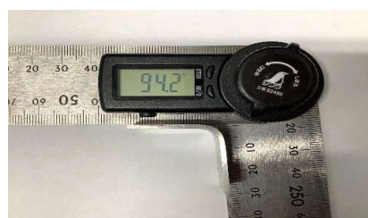
図 13(b) AZT912 のスプリングバック
