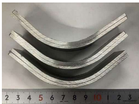
図 10(a) 曲げ試験片 (AZ31, R/t=6.1 ) 図 10(b) 曲げ試験片 (繰り返し曲げ, R/t=2.4 )
