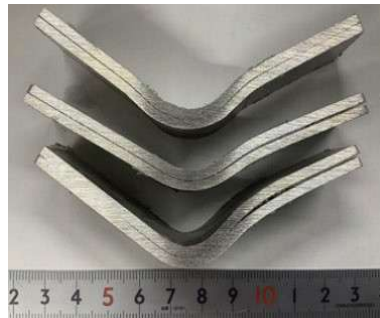
図16(a) 三層材V曲げ試験結果 (回転ダイあり)
