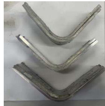
図16(b) 三層材V曲げ試験結果 (回転ダイなし)
