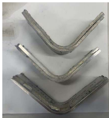
図 12 回転式ダイによる成形例
