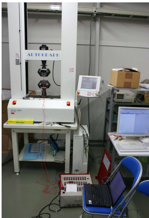
図27 樹脂/高強度Mg合金二層積層材の引張試験の様子
