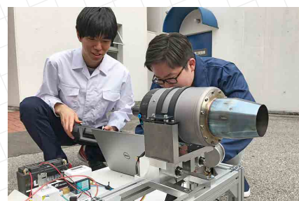
小型ジェットエンジンの性能実験。小型エンジンを使って推力を測定します。
